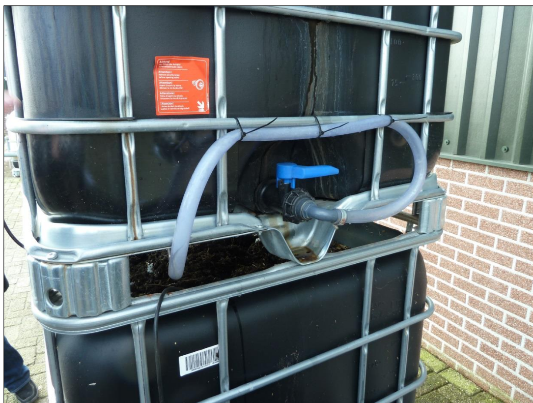
Rys. 43. Odbiór odcieków z kontenerów kolumny stanowiska BIOFILTER
