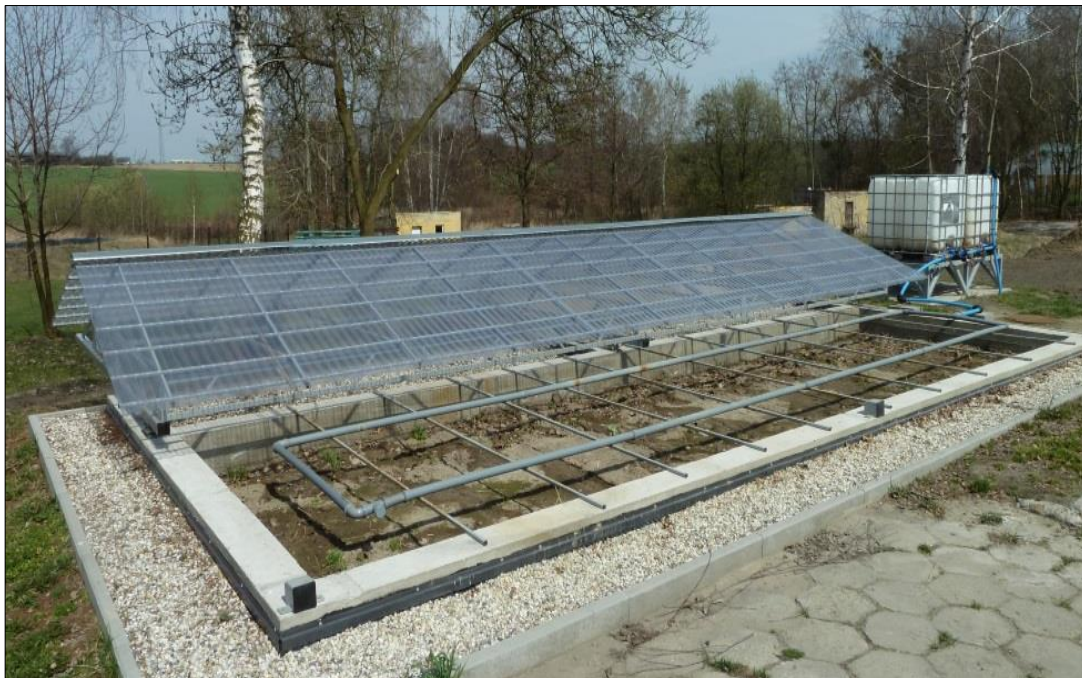
Rys. 28. Stanowisko bioremediacyjne PHYTOBAC z odsuwającym dachem
