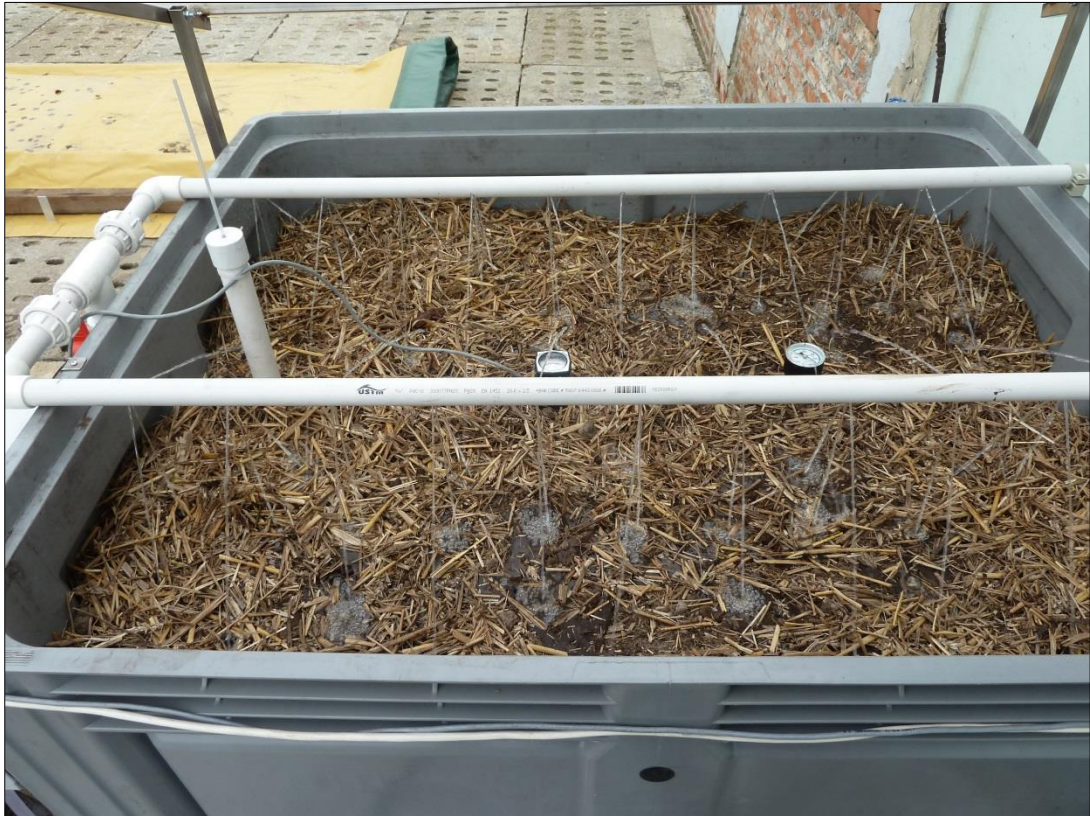
Rys. 50. Nanoszenie płynnych pozostałości na substrat stanowiska VERTIBAC
