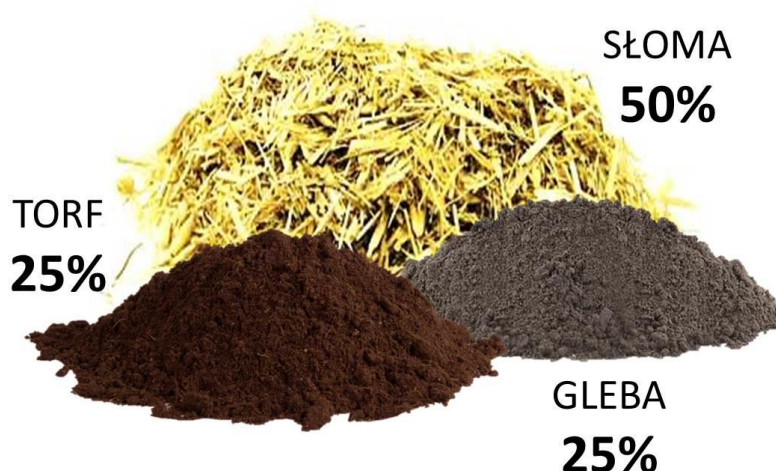
Rys. 13. Składniki bioaktywnego substratu glebowego wykorzystywanego w stanowiskach bioremediacyjnych
