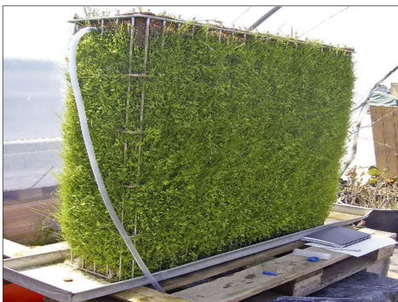
Rys. 52. ZIELONY BIOBED w formie pojedynczej klatki
